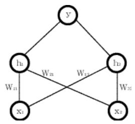
入力層を x、中間層を h、出力層を y とします。入力層と中間層のあいだの結合係数が  $W_{ij}$ です。 $W_{ij}$ というのは、入力層の  $x_{j}$ という細胞から,中間層の  $h_{i}$ という細胞への,結合荷重を表しています。
